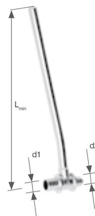
**KAN-therm** отвод фиксируемый из PPSU Push (гнездо для крана), с короткой полимерной заглушкой
