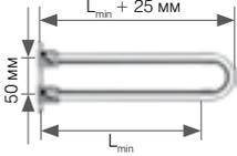
**KAN-therm отвод фиксируемый из PPSU Push (гнездо для крана), с короткой полимерной заглушкой**
